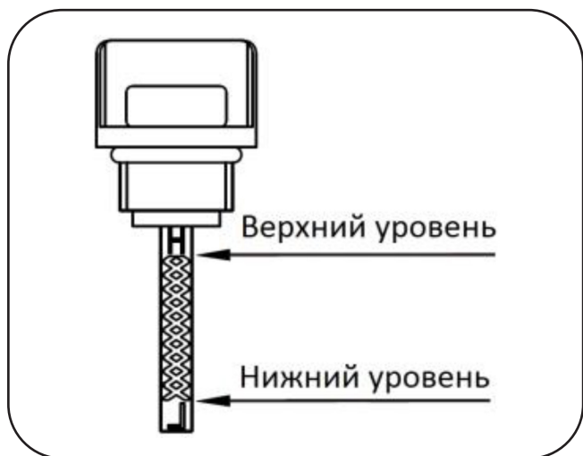
Рисунок 3. Отметки на масляном щупе.
