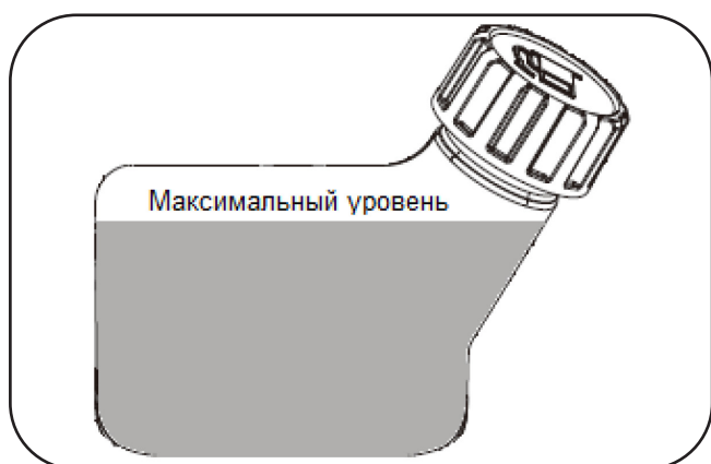
Рисунок 5. Максимальный уровень заполнения топливного бака.
