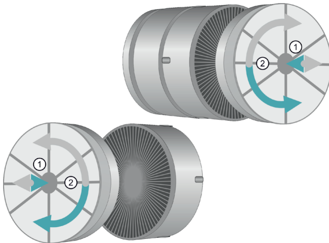
Рис. 14 Установка угольного фильтра
