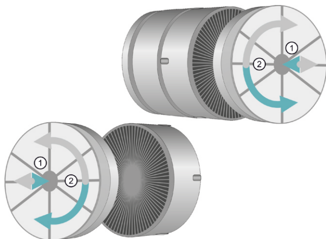
Рис. 14 Установка угольного фильтра
